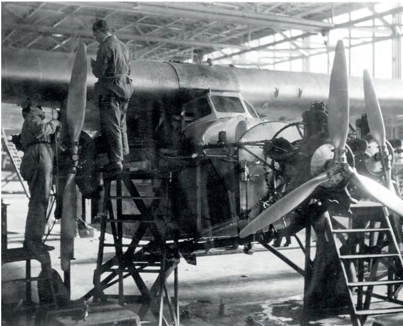
Boven: Een Fokker F.VII in aanbouw [foto: Collectie Theo Wesselink]
